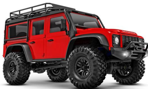
Figura 3-1 Plataforma móvil empleada en el proyecto, basada en un vehículo teledirigido Land Rover Defender TRX4, que sirve como base para la integración de los distintos sensores y sistemas de procesamiento. Fuente: [47]
