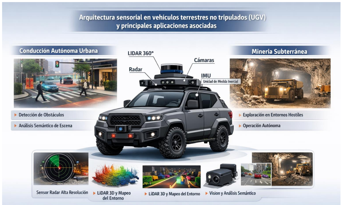
Figura 2-6 Arquitectura sensorial en vehículos terrestres no tripulados (UGV) y principales aplicaciones asociadas. Fuente: Elaboración asistida por herramientas de inteligencia artificial
