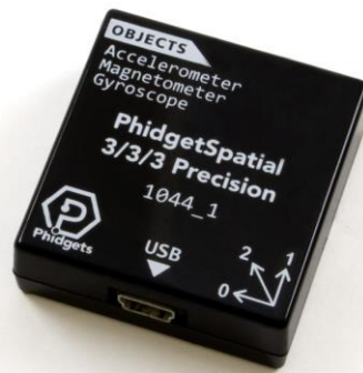
Figura 3-9 Sensor inercial PhidgetSpatial Precision 3/3/3 empleado para la medida de aceleraciones, velocidades angulares y orientación del vehículo. Fuente: [17]
