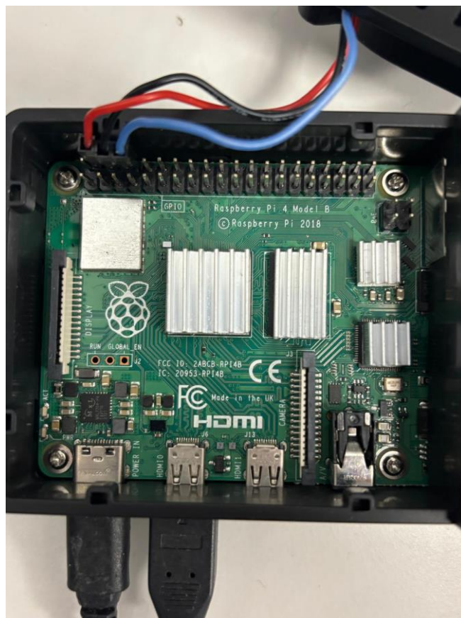
Figura 3-2 Raspberry Pi 4 Model B empleada como unidad central de procesamiento para la adquisición, sincronización y gestión de los datos procedentes de los distintos sensores del sistema
