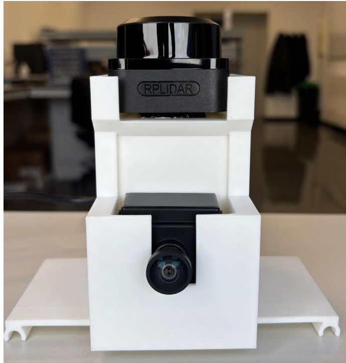
Figura 3-17 Soporte impreso en 3D diseñado para la integración conjunta del sensor LiDAR y la cámara USB. La pieza permite alojar ambos dispositivos en una única estructura, posicionando el LiDAR en la parte superior y la cámara en la zona frontal del soporte
