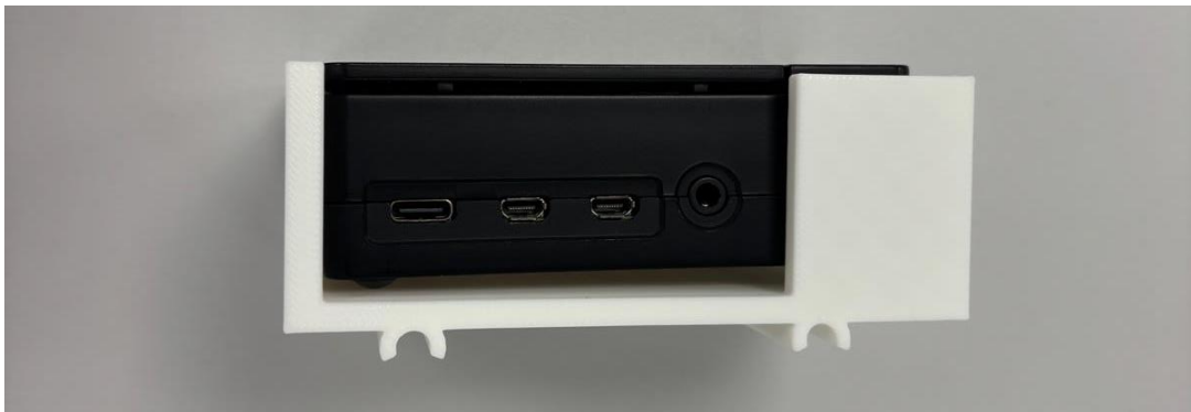
Figura 3-19 Soporte impreso en 3D destinado al alojamiento de la Raspberry Pi, diseñado para integrarse dentro de la estructura superior del vehículo y permitir el acceso a los distintos puertos de conexión
