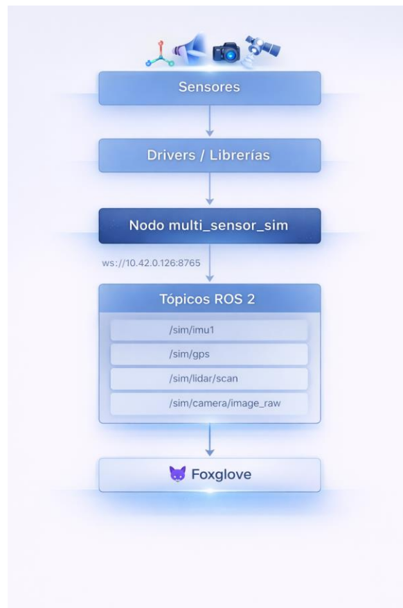
Figura 3-37 Arquitectura modular del sistema multisensor, organizada en capas desde la adquisición de datos hasta su visualización. Fuente: Elaboración asistida por herramientas de inteligencia artificial
