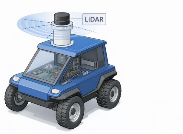
Figura 3-6 Esquema inicial de la ubicación del sensor LiDAR sobre un soporte cilíndrico elevado en la parte frontal del techo del rover. Fuente: Elaboración propia mediante generación asistida por inteligencia artificial
