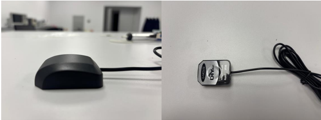
Figura 3-12 Receptor GNSS con conexión USB empleado para la obtención de información de posicionamiento global del vehículo
