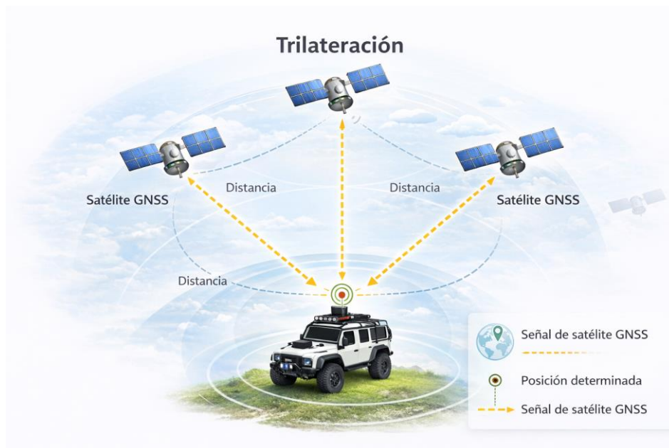
Figura 3-13 Esquema conceptual del sistema de posicionamiento global (GNSS), en el que varios satélites GNSS transmiten señales al vehículo, que actúa como receptor para la determinación de su posición. Fuente: Elaboración propia mediante generación asistida por inteligencia artificial
