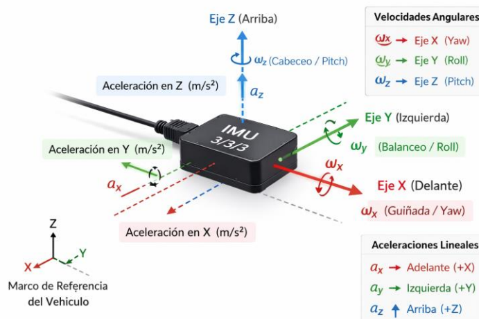
Figura 3-10 Sistema de ejes de referencia de la unidad de medida inercial (IMU), mostrando las aceleraciones lineales y las rotaciones medidas en los tres ejes espaciales X, Y y Z. Fuente: Elaboración propia mediante generación asistida por inteligencia artificial
