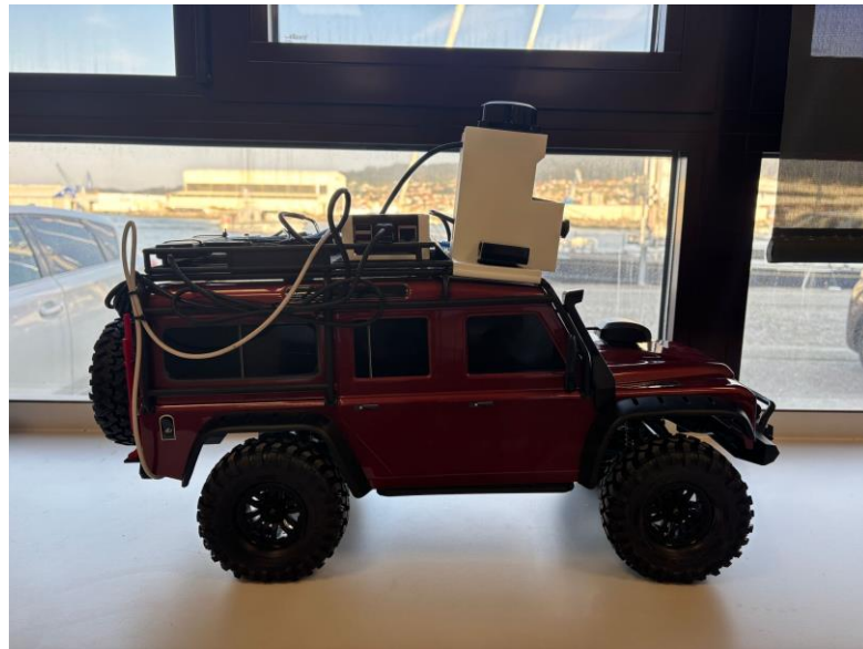
Figura 4-1 Plataforma experimental utilizada durante las pruebas, incluyendo la integración de los sensores y la unidad de procesamiento embarcada
