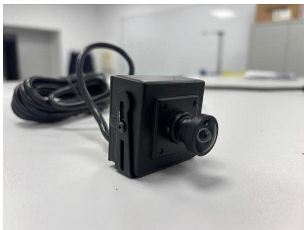
Figura 3-7 Cámara USB de 2.0 megapíxeles empleada como sistema de visión para la captura de imágenes en color del entorno
