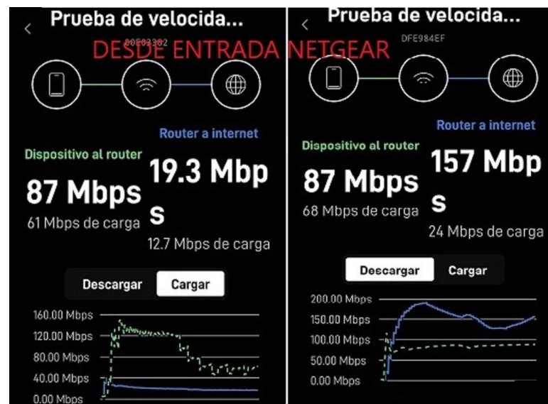
Figura 38.- Test velocidad desde toma de red Radio Principal a Switch Netgear de distribución de la fragata “Cristóbal Colón”. Fuente: Personal destino de la Radio del buque. [10]
