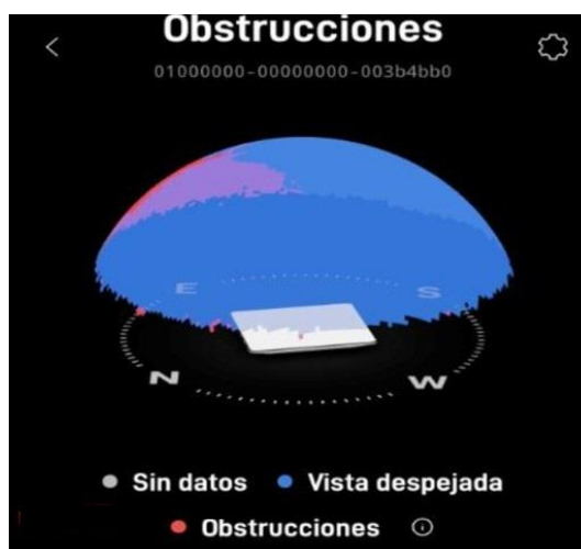
Figura 32.- Cobertura antena Starlink en la fragata “Cristóbal Colón”. Fuente: Personal destino de la Radio del buque. [10]
