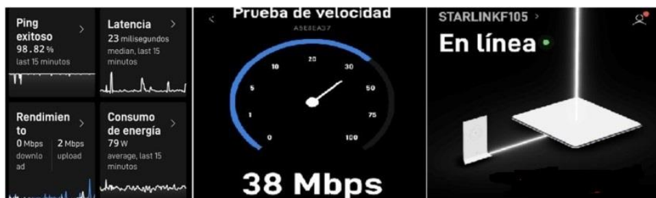
Figura 35.- Mediciones router Starlink en la fragata “Cristóbal Colón”. Fuente: Personal destino de la Radio del buque. [10]
