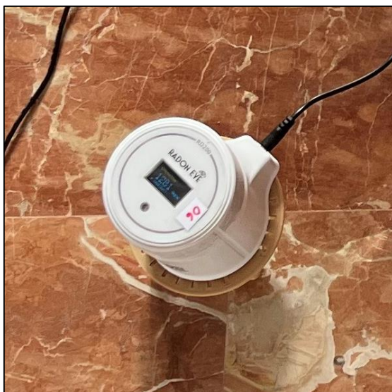
Figura 3-11 Colocación del RadonEye y soporte sobre las juntas del suelo
