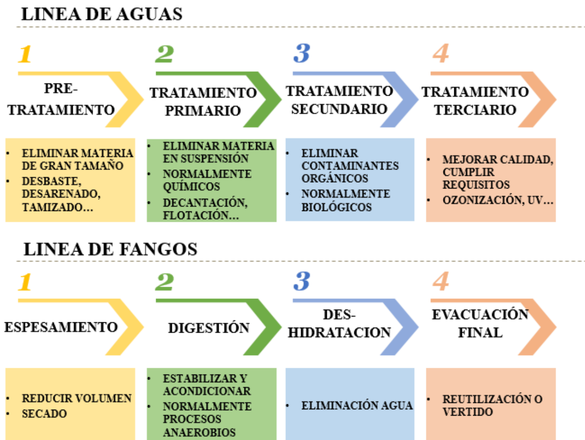
Figura 3-2 Esquema general de los procesos de una EDAR (elaboración propia)
