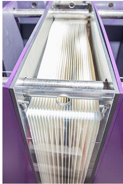
Figura 4-11 Módulo de membranas de placa plana (tomada de [81])
