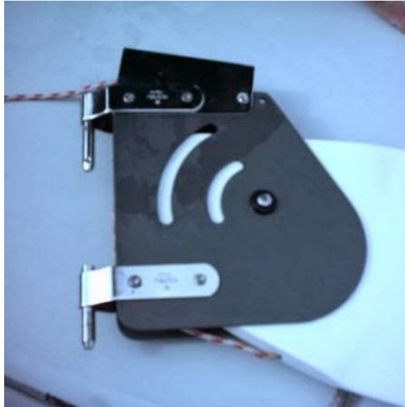
Figura 2-24 Fotografía de sujeciones de la pala del timón de embarcación Snipe
