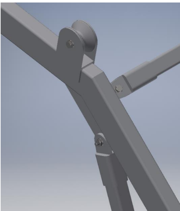
Figura 5-12 Detalles de unión del codo de la barra principal (izquierda) y su extremo (derecha).
