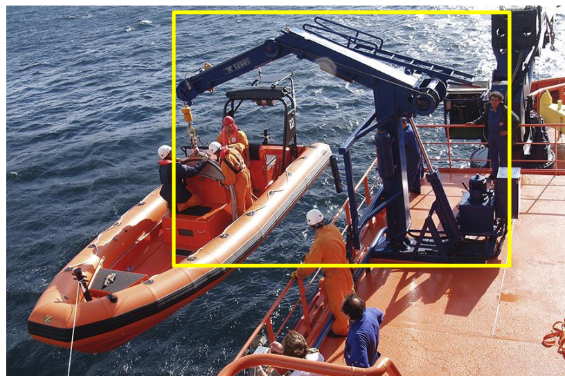
Figura 2-5 Pescante para bote de rescate. Buque de operaciones de rescate (España). [1]
