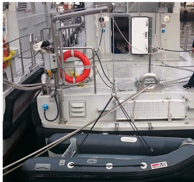
Figura 3-6 Maniobra de arriado de zodiac en lancha de instrucción. [12]
