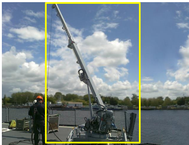
Figura 2-3 Grúa plegable. Fragata (Francia). [1]
