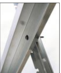
5 Unir los perfiles mediante tornillos.
