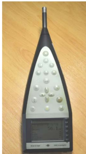
Figura 3-18 Sonómetro Brüel & Kjaer, modelo 2260. [13]
