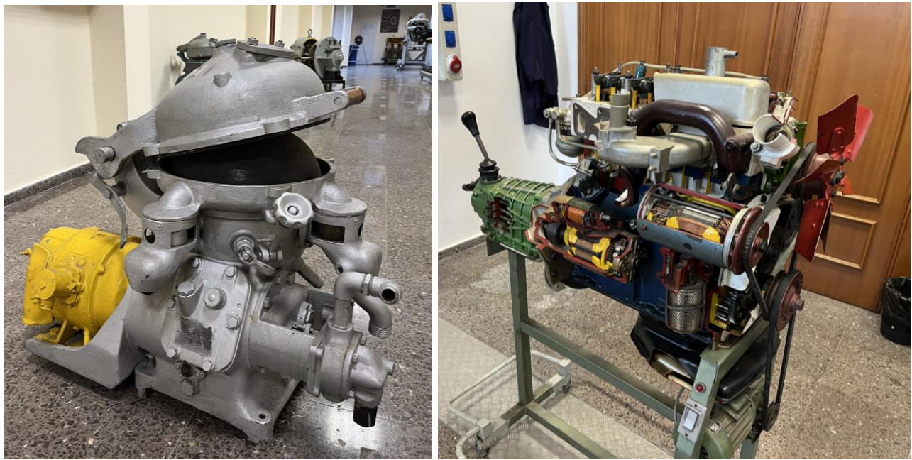
Figura 3-3 Centrifugadora separadora de aceite (izquierda) y motor de combustión interna de cuatro tiempos (derecha)
