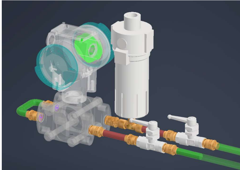
Figura 3-4 Sensor diferencial depresión con purgador automático (Diseño CAD)
