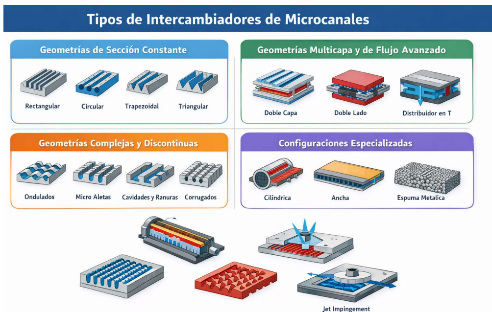
Figura 2-6 Intercambiadores de microcanales según geometría interna (Imagen generada con IA)
