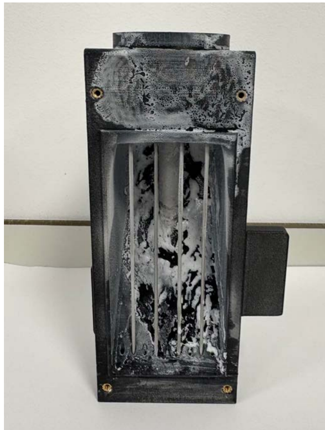
Figura 3-8 Cuerpo principal bañado con spray AESUB
