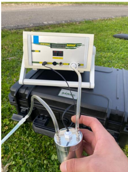
Figura 3-12 Separador de condensados con válvula de flotador.
