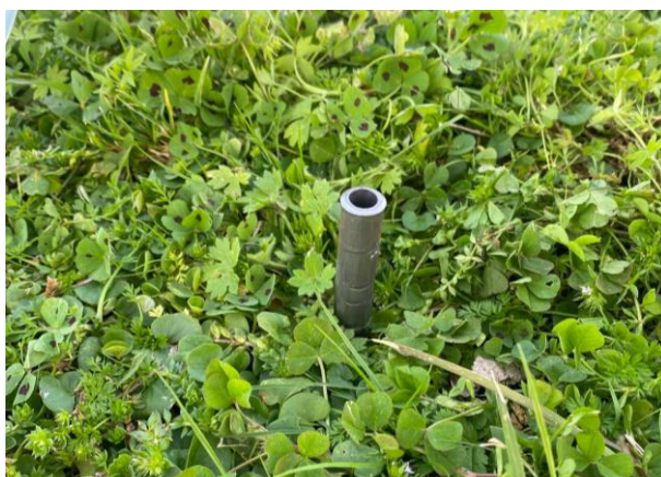
Figura 3-17 Sonda introducida en el terreno.
