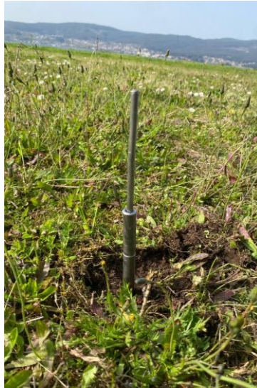
Figura 3-18 Varilla metálica introducida en la sonda.
