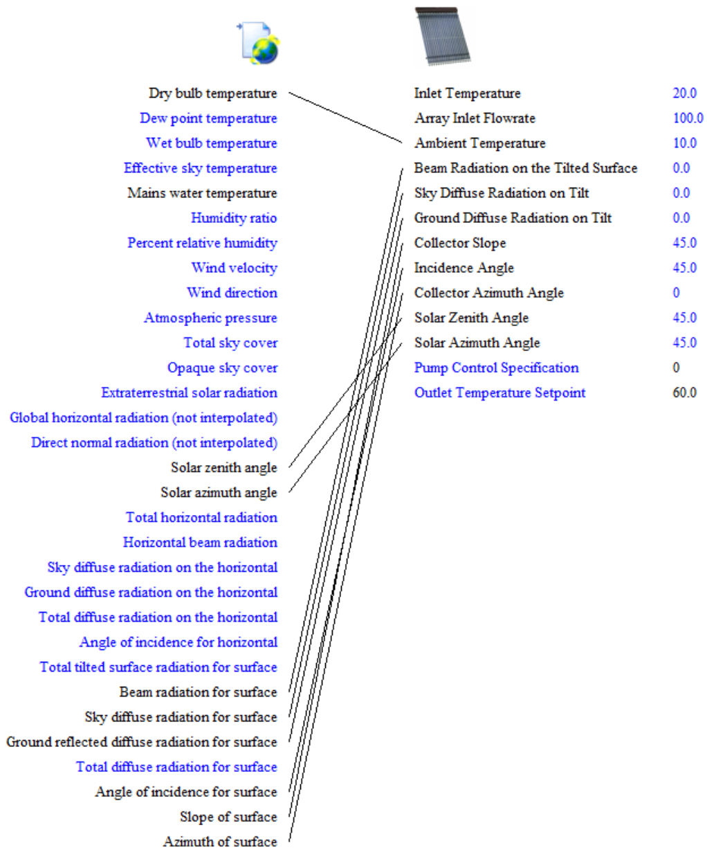
Figura 4-22 Parámetros enlazados entre el archivo meteorológico y el colector solar
