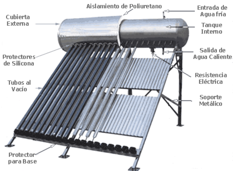
Figura 3-3 Colector de tubos de vacío [14]
