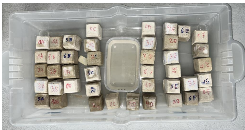
Figura 3-13. Muestras dentro del recipiente en el que se encuentra el KCl.
