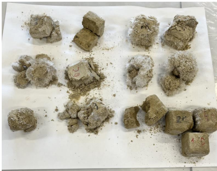
Figura 4-16. Muestras tras 12 ciclos de \text{Na}_2\text{SO}_4 .
