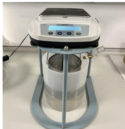
Figura 3-8. Balanza colocada para la medición del peso hidrostático.
