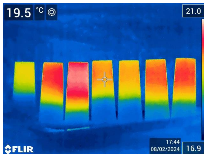
Figura 4-4. Morteros tras dos horas (final) de ensayo (escala automática).
