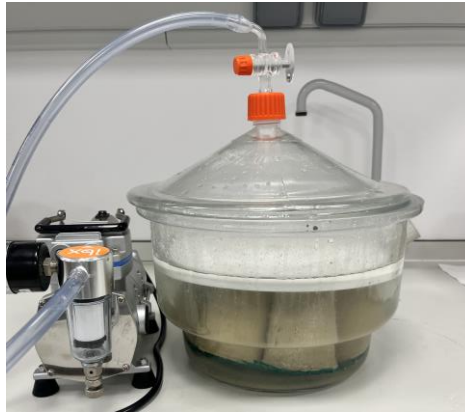
Figura 3-11. Muestras sometidas a saturación en el desecador.
