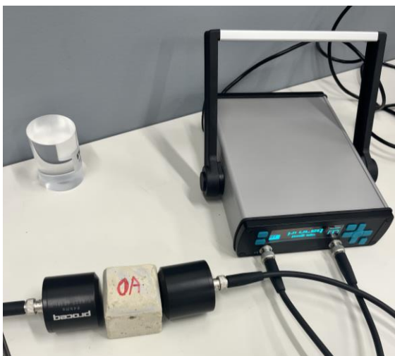
Figura 3-6. Imagen tomada durante la realización del ensayo de ultrasonidos.
