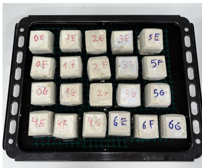
Figura 3-9. Muestras sometidas al ensayo de capilaridad
