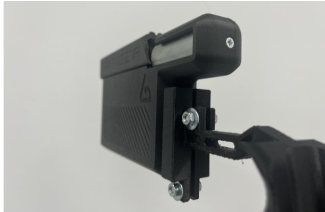
Figura 4-16 Sistema de agarre del dispositivo de respuesta háptica
