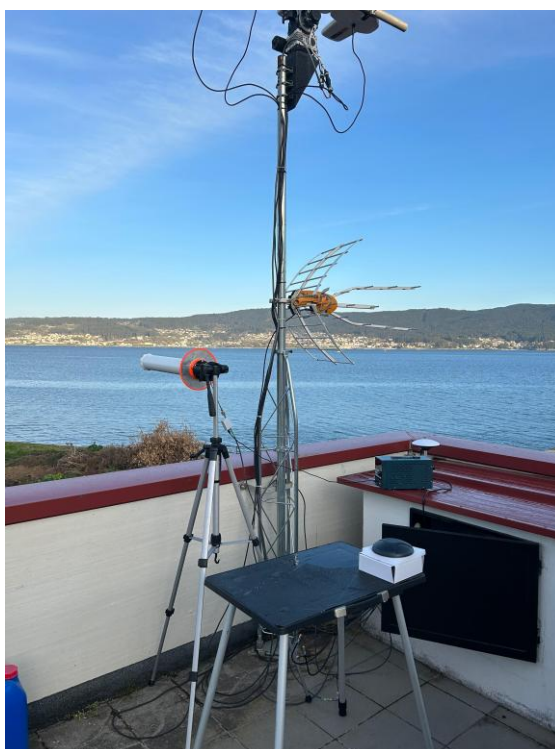
Figura 3-23 Montaje con antena de referencia y antena de vigilancia.
