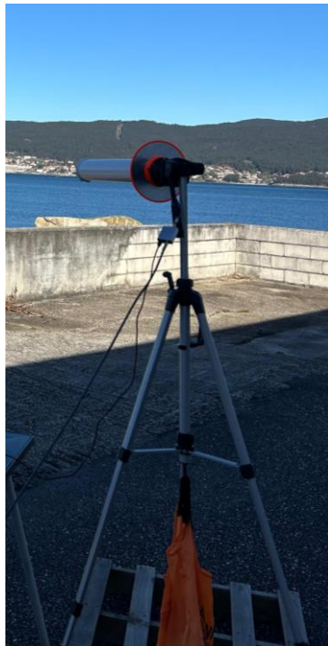
Figura 3-4 Antena RHCP de Nolle Engineering y sus especificaciones.
