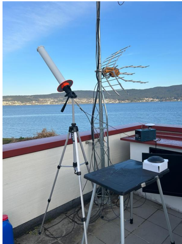
Figura 3-26 Antena de vigilancia ajustada a la posición del satélite.
