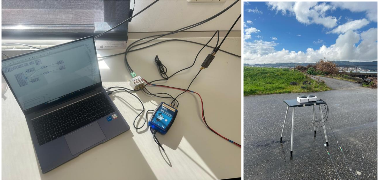
Figura 3-20 ADALM-Pluto conectado a GPSDO y a las dos antenas.
