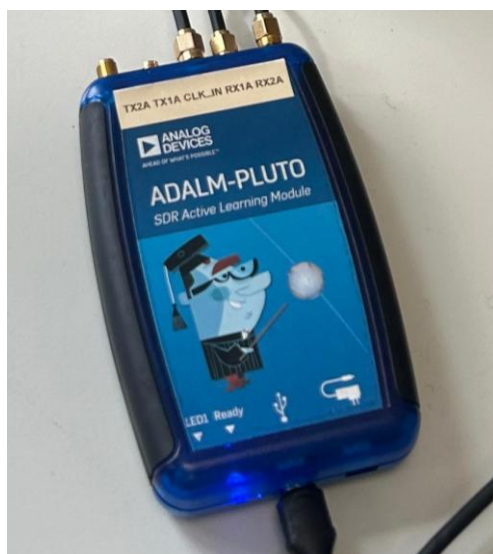
Figura 3-19 ADALM-Pluto con 2 entradas y 2 salidas.
