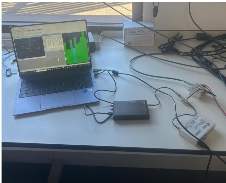
Figura 3-18 Montaje para prueba con HackRF y 1 antena de referencia.
