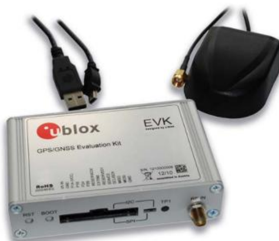
Figura 3-5 Receptor GNSS EVK-M8T de UBLOX.
