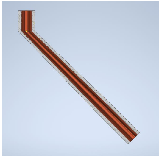
Figura 5-2 Vista seccionada conducto de alimentación (Elaboración propia)
