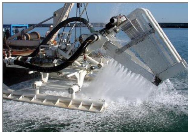
Figura 3-9. Sistema para realizar enterramiento jeting [29].
