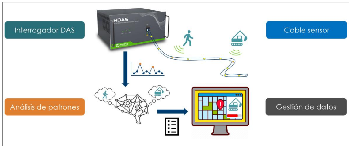
Figura 3-26. Partes de una solución DAS [52].
