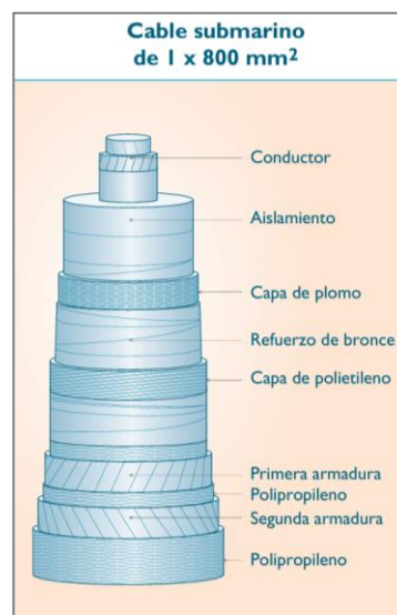
Figura 3-6. Ilustración de un cable submarino eléctrico [30].
