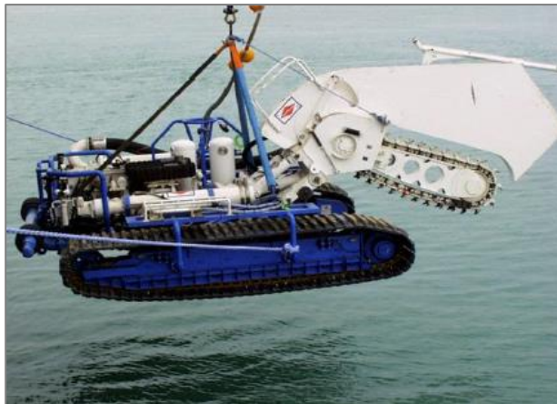
Figura 3-10. Equipo para efectuar enterramiento trencher [29].
