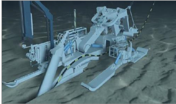
Figura 3-8. Enterramiento plough o arado de enterramiento [29].
