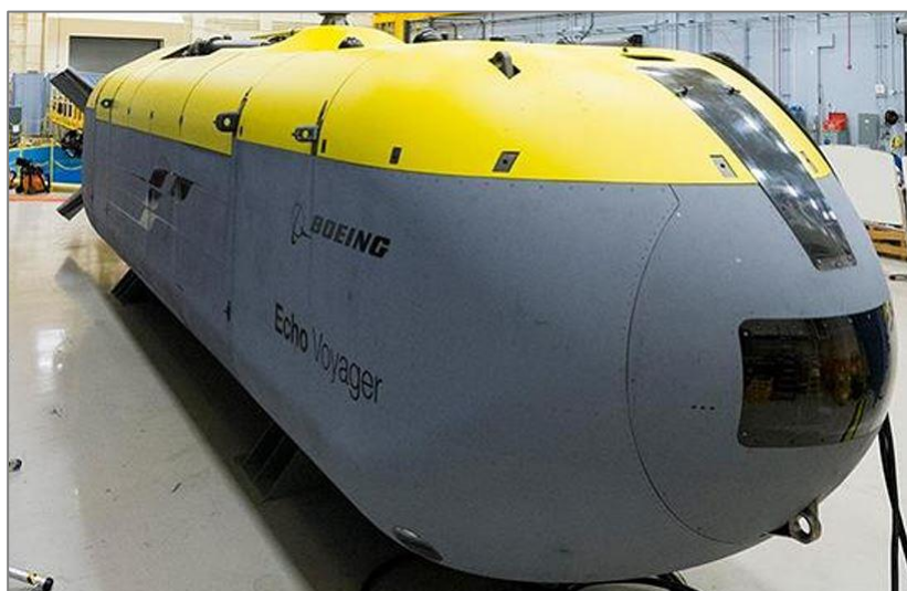
Figura 3-19. Ejemplo de un vehículo submarino autónomo (UUV) [50].
