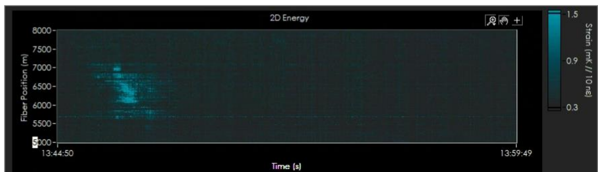
Figura 3-35. Captura de datos del equipo DAS en el momento del cruce del barco por encima del cable submarino de Red Eléctrica de España [54].
