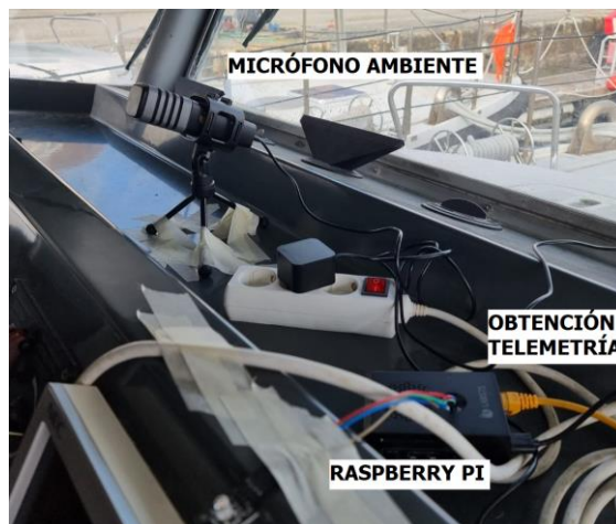
Figura 3-4: Instalación del sistema en lancha junto micrófono ambiente. Fuente: propia.
