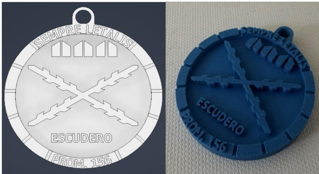
Figura 3-27 Modelo CAD y resultado tras fabricación mediante impresión 3D.
