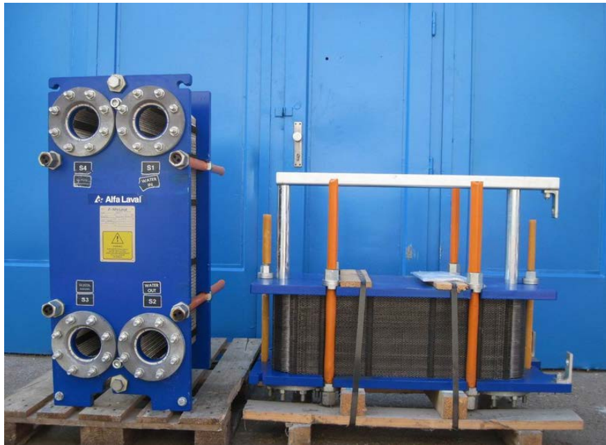
Figura 9-6 Intercambiador de placas ALFA LAVAL M10-BFM (Fuente ALFA LAVAL)
