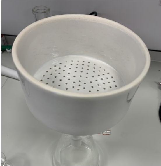
Figura 3-3 Embudo Büchner//Sistema kitasato.
