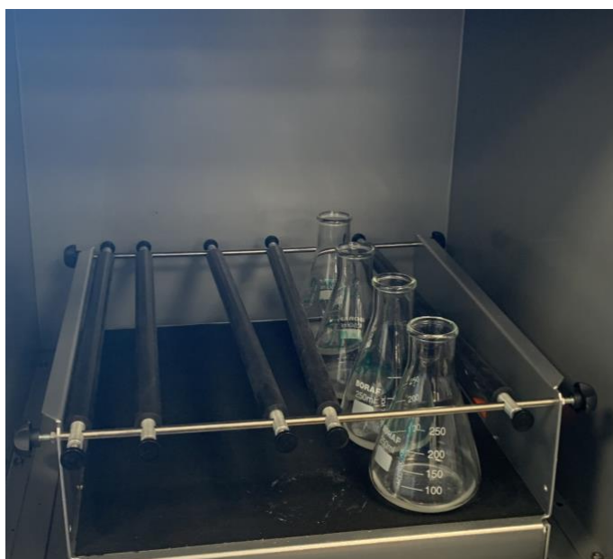
Figura 3-10 10 mL de cada disolución sometidas a 42 min de agitación.
