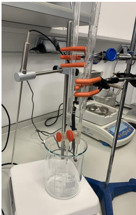
Figura 3-1 Montaje de las buretas y vaso para la preparación de la disolución.
