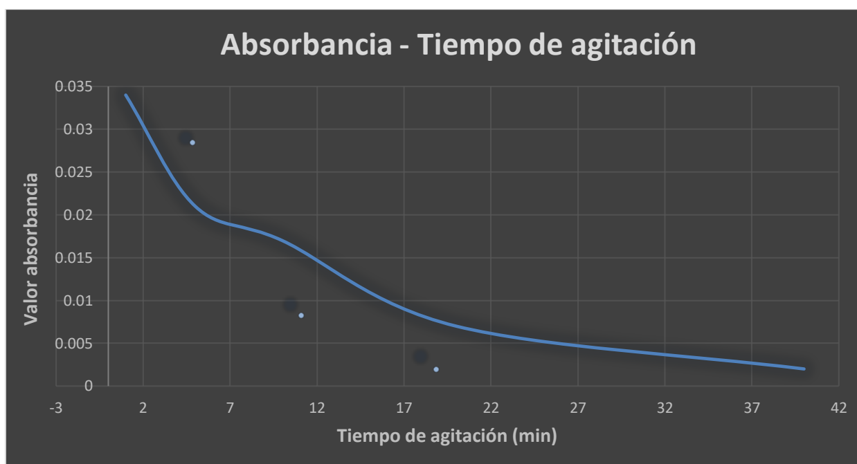
Figura 4-10 Gráfica absorbancia - tiempo para el fosfato con HDT calcinada (42 min).
