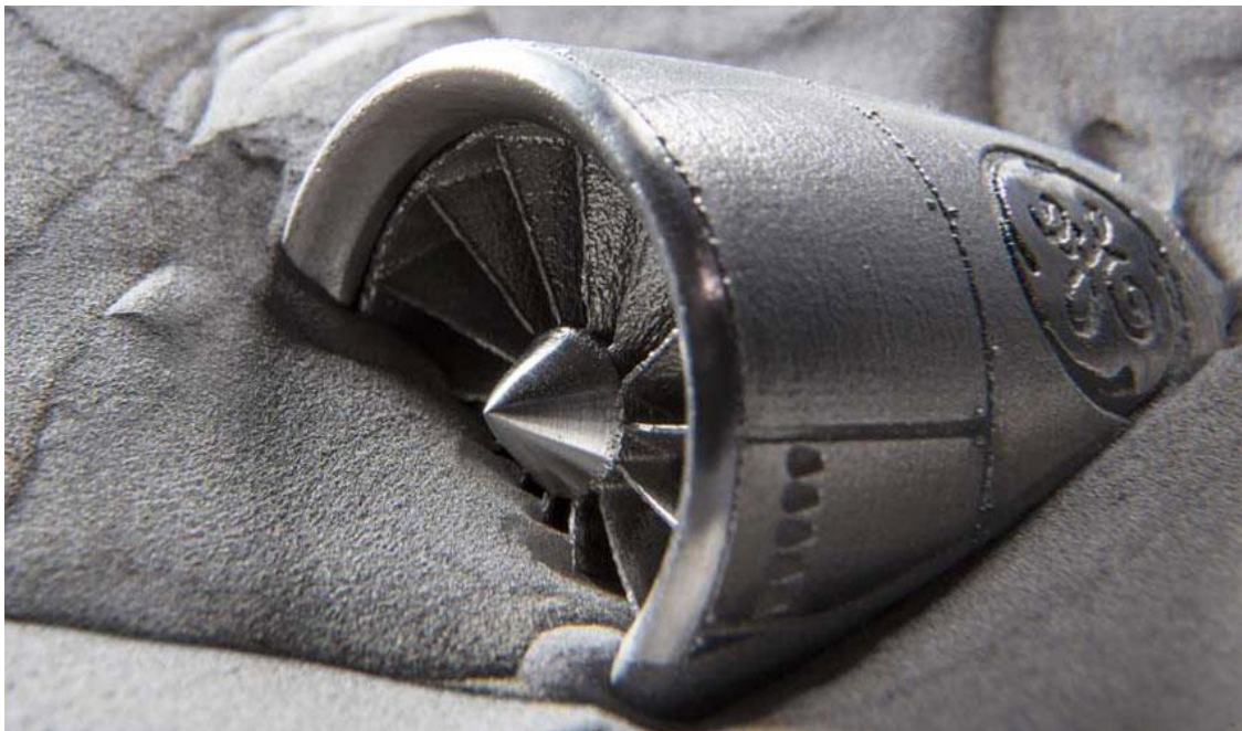
Figura 2-6 Turbina realizada con material metálico mediante fabricación aditiva [8]
