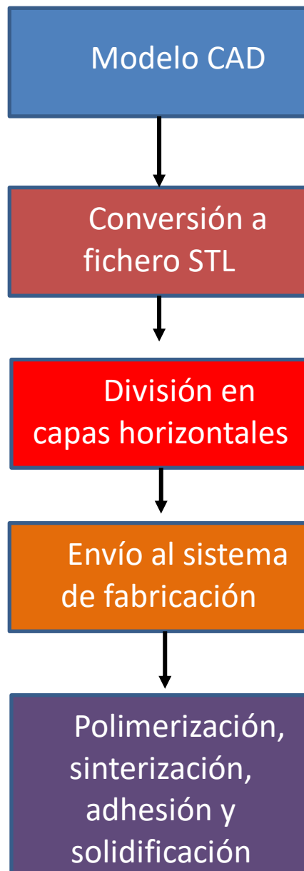
Figura 2-2 Etapas de la fabricación aditiva
