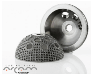
Figura 2-22 Ejemplo de resultado de fabricación por haz de electrones [24]
