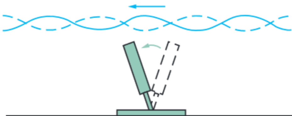
Figura 2-12 Esquema de funcionamiento de un convertidor de movimiento oscilante [36]
