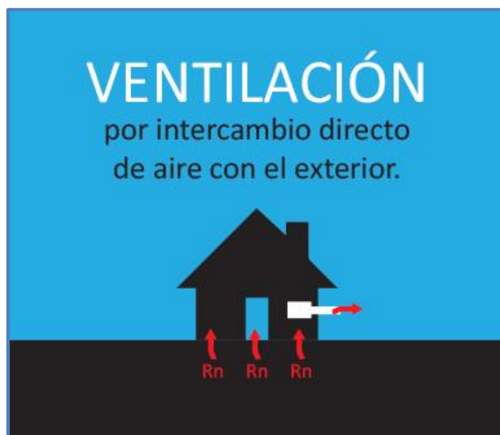
Figura 2-5: Esquema de ventilación de radón [19].
