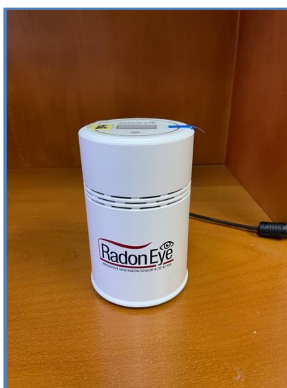
Figura 3-1: Sensor RadonEye RD200.
