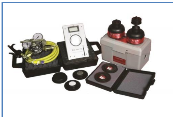
Figura 2-3: Sistema E-PERM de medición de gas radón. Fuente: [16]
