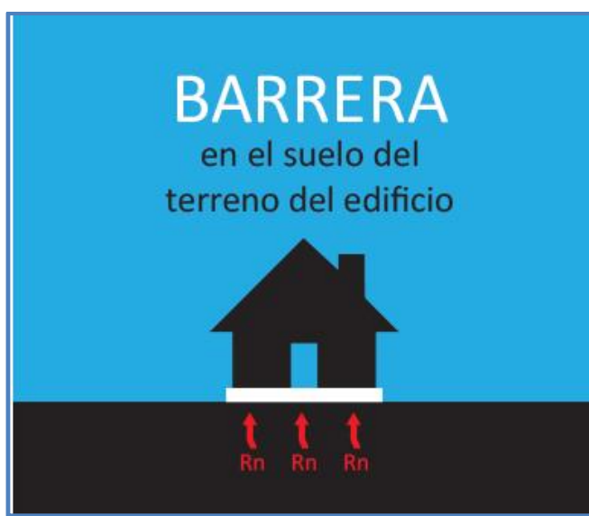
Figura 2-6: Esquema de barrera de protección anti-radón [19].
