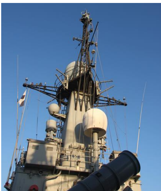
Figura 2-10 Mástil con el receptor ESM en el tope y las dos antenas emisoras del P-78 Cazadora (clase “Descubierta”). [16]
