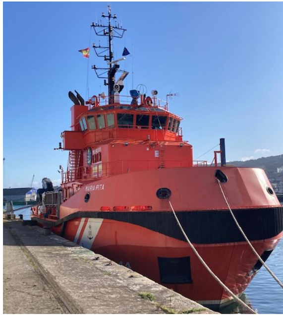
Figura 3-31 Buque de Salvamento Marítimo BS-14 María Pita atracado en el muelle de Torpedos con radar bajo (banda S) y alto (banda X).
