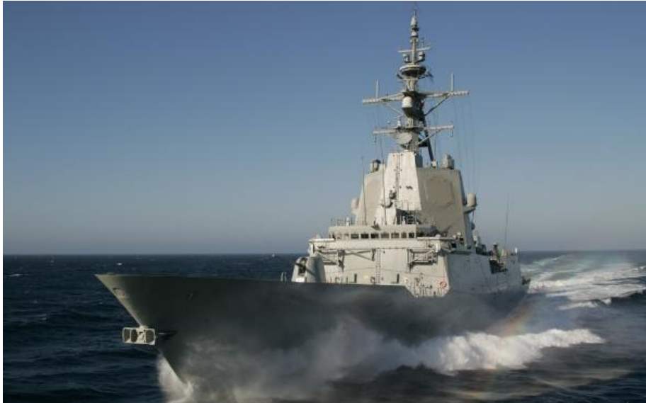
Figura 2-11 Antenas ESM/ECM en el mástil del sistema Aldebarán de la F-102 A. Juan de Borbón. [17]
