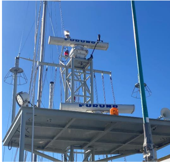
Figura 3-8 (Radares 1944C FURUNO) alto y bajo de la Lancha de Instrucción A-124 (GM. Salas).
