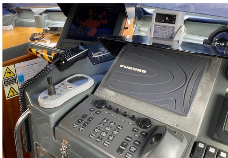
Figura 3-30 Puesto de la patrullera de Aduanas Águila I con radar FURUNO FAR-2827.
