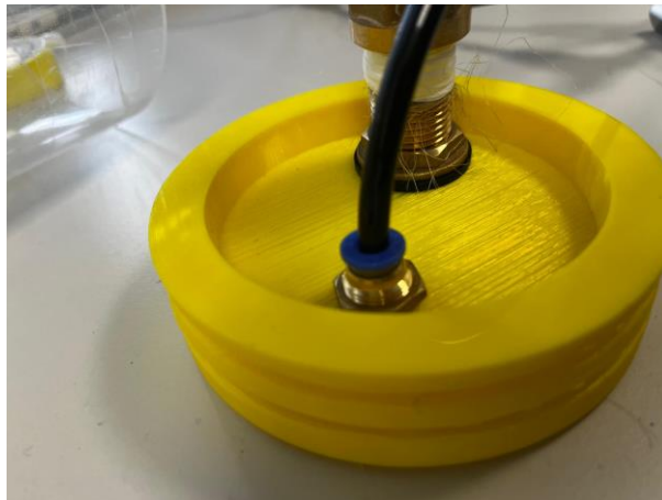
Figura 4-8 Imagen del pasamamparos en su posición de uso (Fuente propia).
