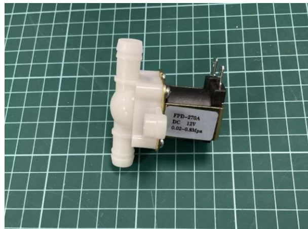
Figura 4-10 Imagen de válvula solenoide del sistema hidráulico (Fuente propia).
