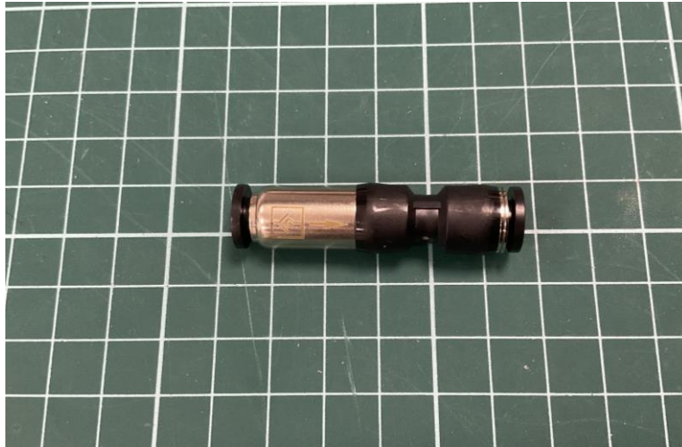
Figura 4-5, Imagen de válvula antirretorno empleada para cada una de las electroválvulas (Fuente propia).
