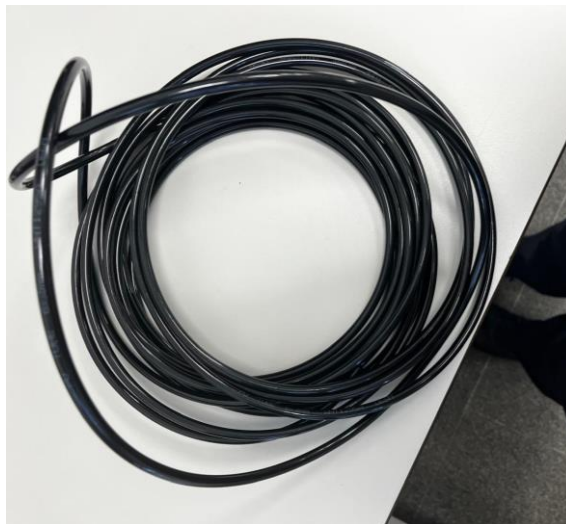
Figura 4-7 Imagen de tubo continente del aire a presión (Fuente propia).
