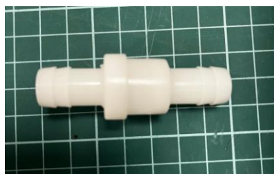
Figura 5-1 Imagen de nuevas válvulas antirretorno implementadas en el sistema hidráulico (Fuente propia).
