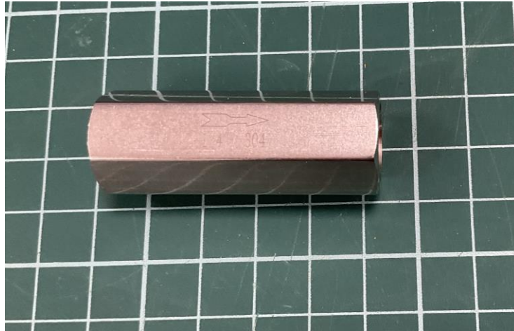
Figura 4-11 Imagen de válvula antirretorno del sistema hidráulico (Fuente propia).
