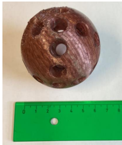
Figura 4-11. Esfera 60 mm impresa mediante FDM (Fuente: Elaboración propia)
