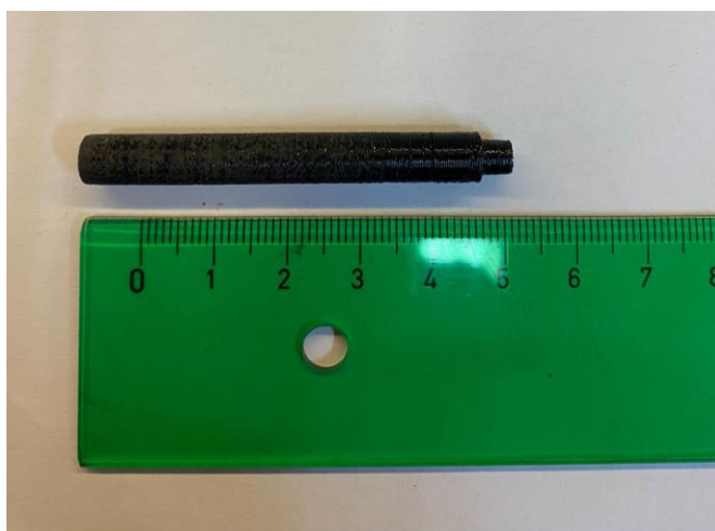
Figura 4-9. Barra 2 impresa mediante FDM (Fuente: Elaboración propia)
