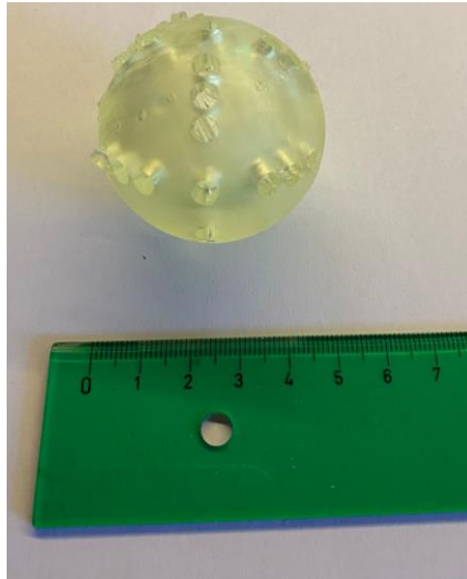
Figura 4-20. Esfera de 45 mm impresa mediante SLA (Fuente: Elaboración propia)
