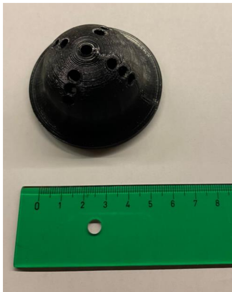
Figura 4-33. Soporte de la esfera fabricado mediante FDM (Fuente: Elaboración propia)
