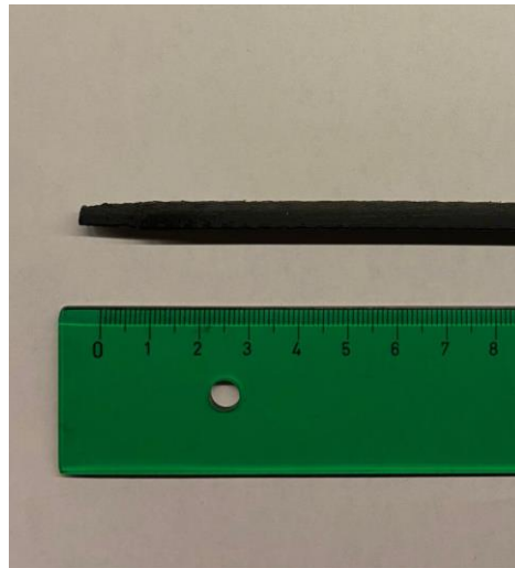
Figura 4-30. Barra de diseño 4 impresa mediante FDM, con modificación en el extremo para permitir una correcta unión (Fuente: Elaboración propia)
