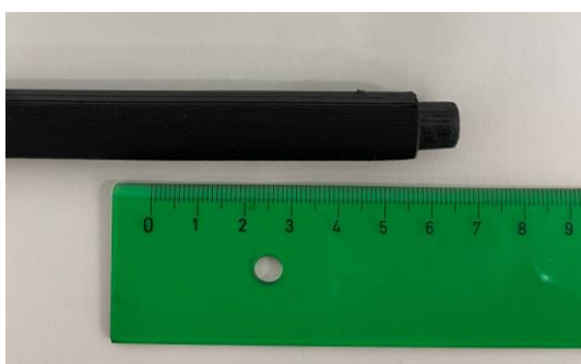
Figura 4-13. Barra 3 impresa mediante FDM (Fuente: Elaboración propia)
