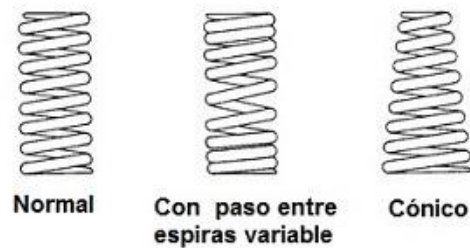
Figura 2-8 Tipos de muelles según su forma [20].
