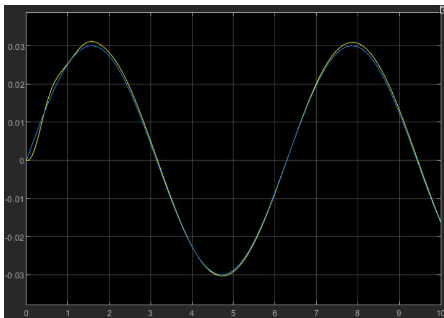
Figura 4-15 Posición vertical del vehículo para 2 GL y 1D en Simscape. (Autoría propia)
