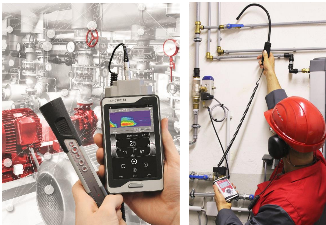
Figura 2-13 Representación gráfica ultrasonidos mediante equipo “Sonotek Sonaphone”
