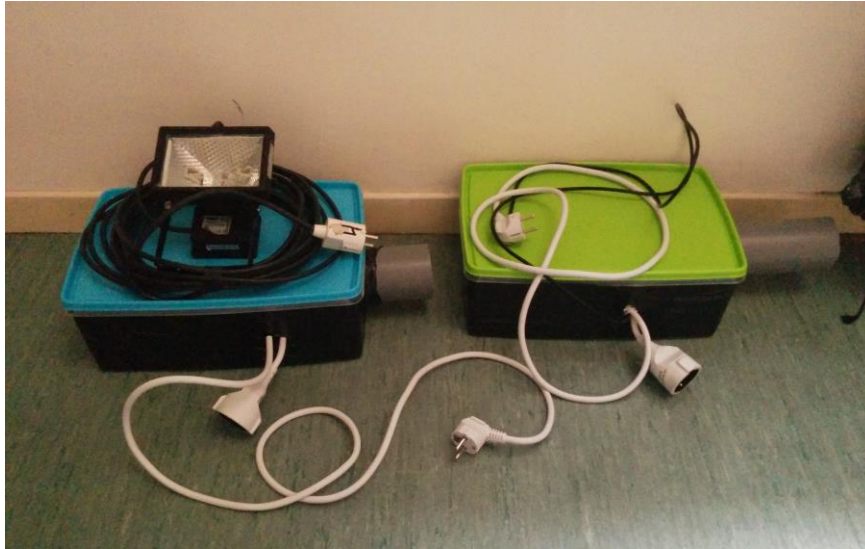
Figura 3-3 Prototipos recién acabados (a falta de los relés para incorporar los focos halógenos)
