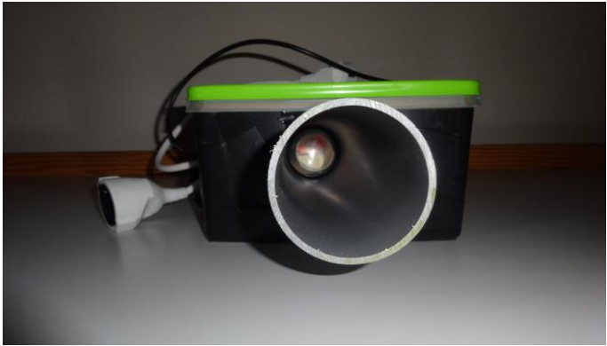
Figura 4-16 Imagen frontal de uno de los prototipos (a través del tubo tras la lupa se aprecia el fotorresistor)
