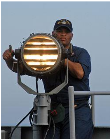
Figura 2-3 Marinero de la marina de Estados Unidos transmitiendo (manualmente) un mensaje por morse mediante destellos de luz o Scott [3]
