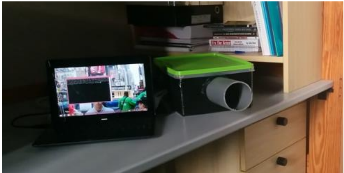
Figura 3-4 Imagen de uno de los prototipos recibiendo durante la prueba (el receptor estaba enfocado hacia el escritorio opuesto de la habitación, donde se encontraba el otro prototipo emitiendo)
