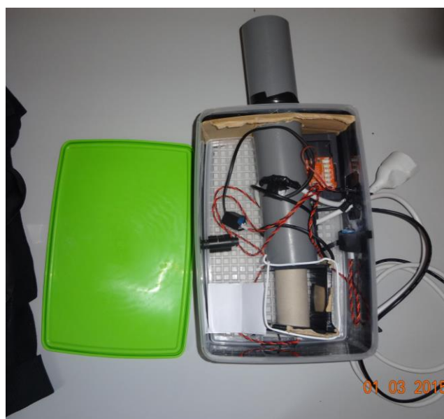
Figura 4-15 Imagen de uno de los prototipos abierto (se aprecia el láser suelto a la derecha del tubo de PVC)
