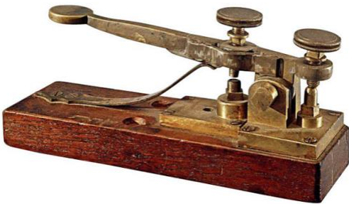
Figure 2-6 Telégrafo eléctrico de finales del siglo XIX [7]
