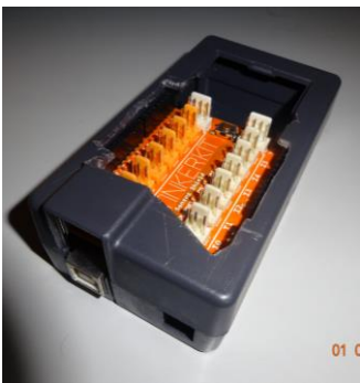
Figura 4-6 Imagen de la caja para Arduino con la placa principal y el shield (apreciese el recorte que se le hizo)
