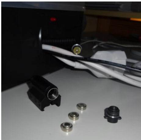
Figura 4-11 Imagen del láser con sus tres pilas de botón y su tapa (se aprecia saliendo del prototipo, la tapa-interruptor que une al láser a su relé correspondiente)
