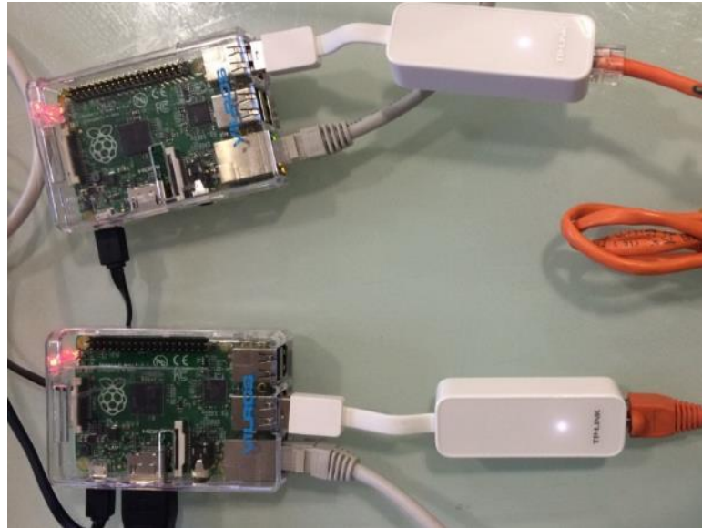
Figura 3-22. Unión de las RPi con cable cruzado
