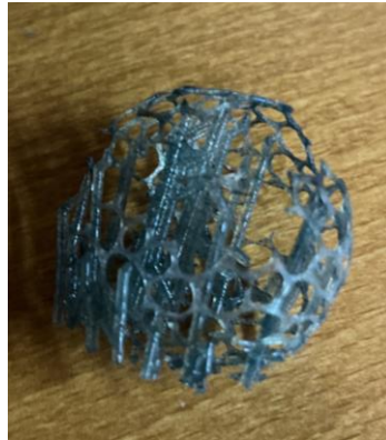
Figura 4-28 Pelota al 2% de espirulina que no ha resistido
