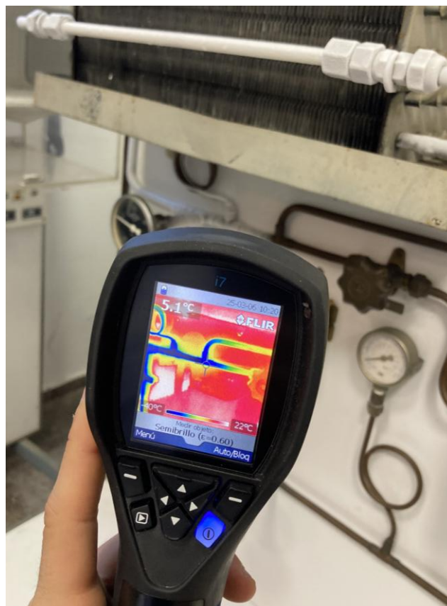
Figura 3-24 Toma de temperatura antes de la válvula de expansión capilar en modo de trabajo "Bomba de Calor".
