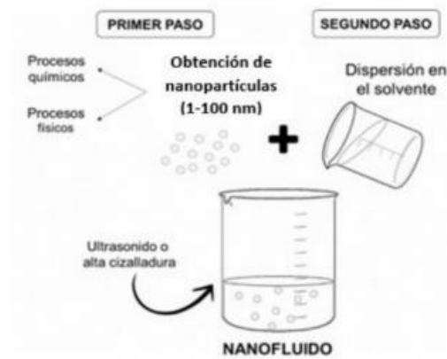
Figura 2-5 Método de síntesis de nanofluidos por dos pasos [23]
