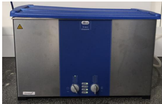
Figura 3-5. Baño ultrasonidos [Fuente propia]
