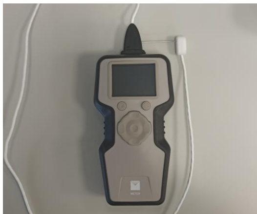
Figura 3-10. Conductivímetro con sensor tipo KS-3 [Fuente propia]
