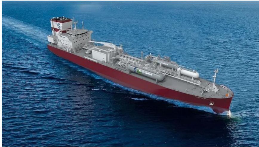
Figura 2-9 Buque con tanques criogénicos a bordo para transportar CO 2 [23]
