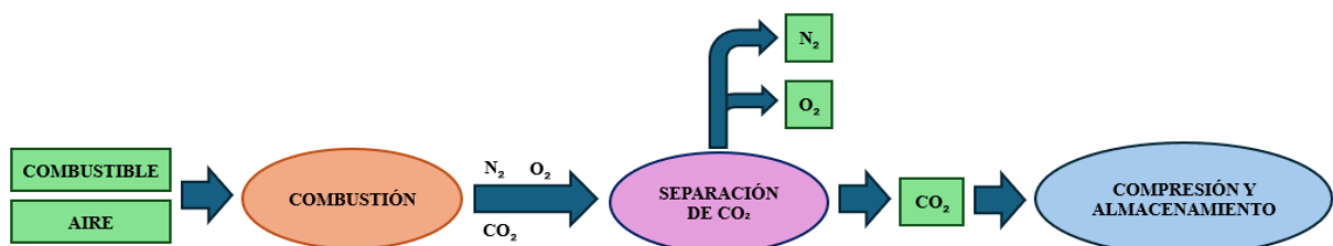
Figura 2-13 Proceso de postcombustión (autoría propia, basado en [31])
