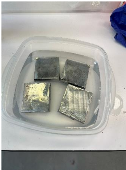
Figura 3-20. Piezas de acero sumergidas en vinagre para activar reacciones químicas (elaboración propia)
