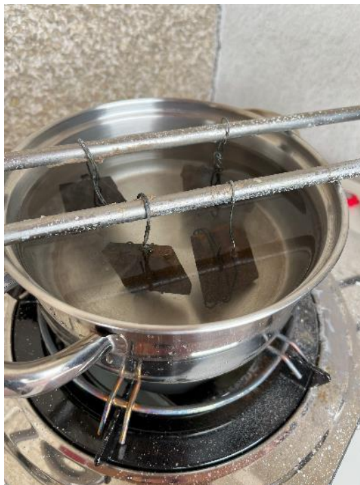
Figura 3-18. Transformación de magnetita del pavonado en óxido de hierro (elaboración propia)
