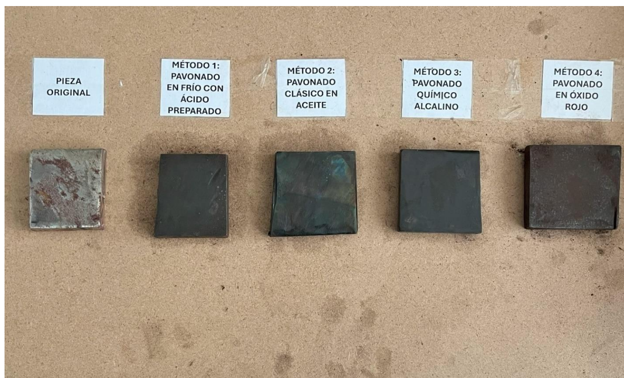
Figura 4-6. Muestras de la piscina tras cuatro semanas de exposición (elaboración propia)
