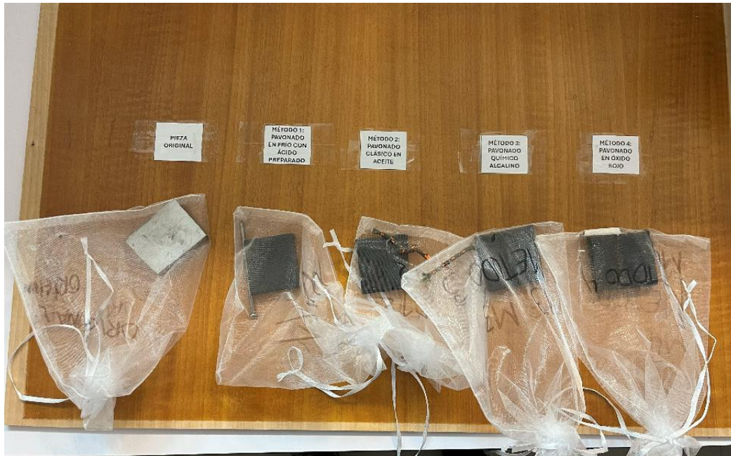
Figura 4-7. Piezas antes de ser sumergidas en el pantalán (elaboración propia)
