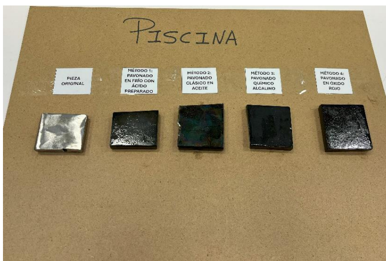
Figura 4-5. Muestras depositadas en la piscina (elaboración propia)
