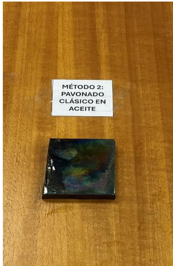
Figura 3-13. Acabado de pavonado al aceite, se aprecia el tono azulado (elaboración propia)
