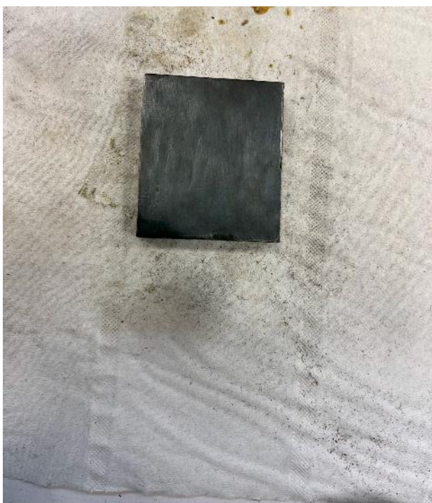
Figura 3-7. Pieza de acero, una vez removido todo el excedente de óxido (elaboración propia)
