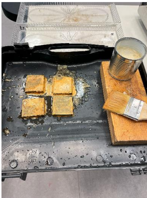
Figura 3-21. Aplicación de oxidante sobre las piezas de acero (elaboración propia)
