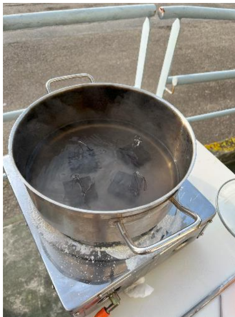
Figura 3-16. Piezas sumergidas en agua destilada hirviendo (elaboración propia)
