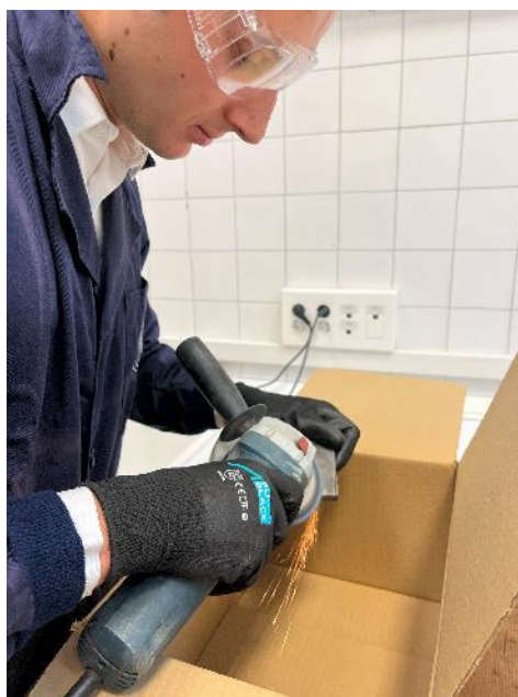
Figura 3-3. Proceso de remoción de impurezas de la pieza de acero (elaboración propia)
