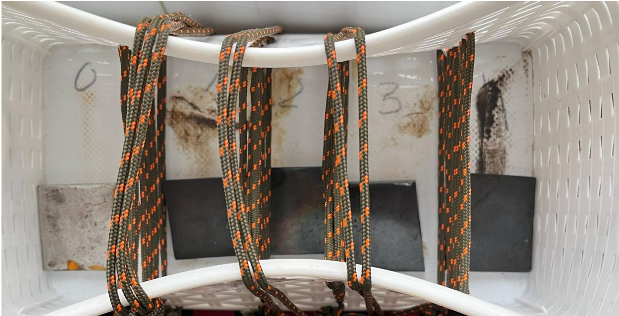
Figura 4-1. Muestras en la cámara de máquinas tras cuatro semanas de exposición (elaboración propia)
