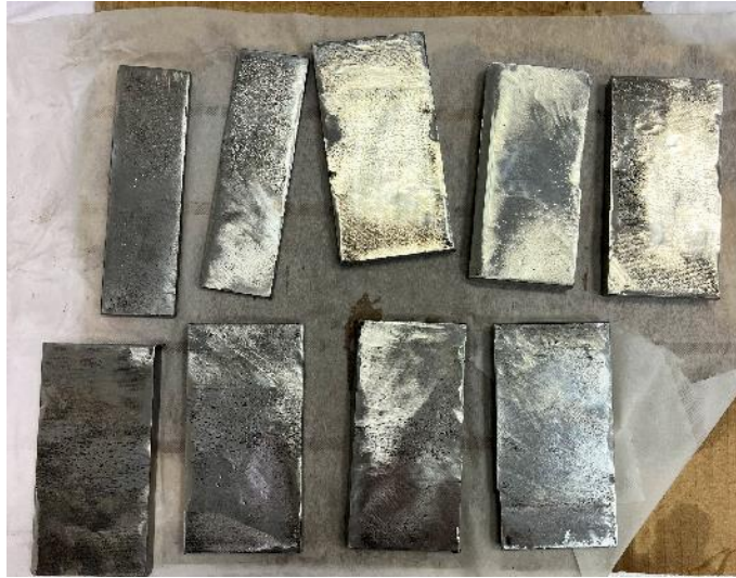
Figura 3-4. Piezas de acero después del proceso de pulido y desengrasado (elaboración propia)
