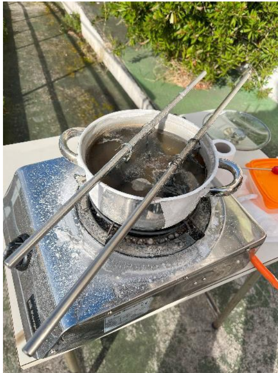
Figura 3-17. Enfriamiento de las piezas en la mezcla de pavonado (elaboración propia)
