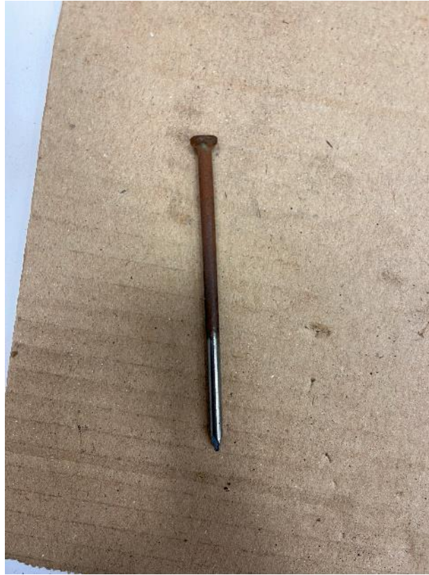
Figura 3-8. Clavo sobre el que se aplicó una capa de pavón y se dejó a la intemperie (elaboración propia)
