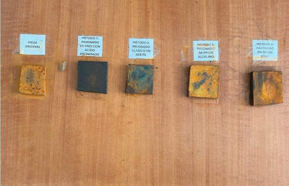
Figura 4-3. Muestra de la terraza tras cuatro semanas de exposición (elaboración propia)
