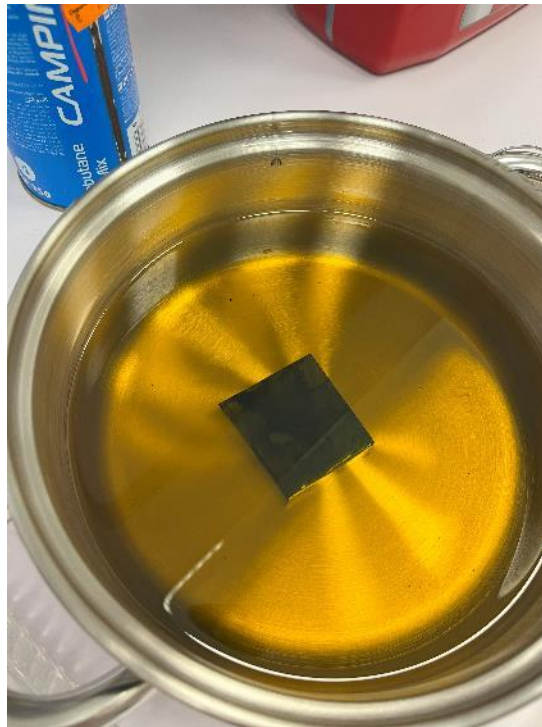
Figura 3-11. Pieza de acero, enfriada tras haberla calentado, sumergida en aceite de motor (elaboración propia)
