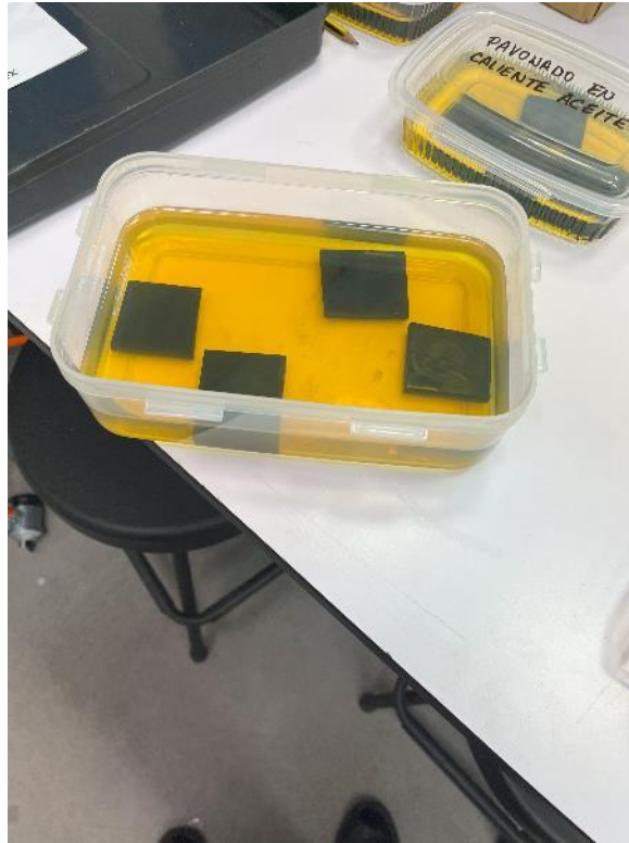
Figura 3-19. Finalización del pavonado, reposo de las piezas en aceite (elaboración propia)
