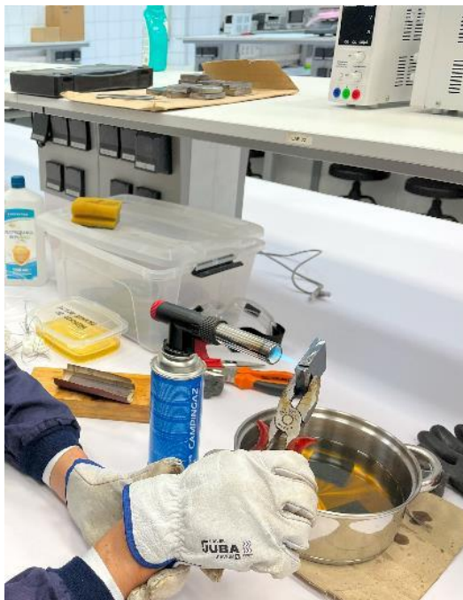
Figura 3-10. Proceso de calentamiento de la pieza hasta alcanzar los 300°C (elaboración propia)
