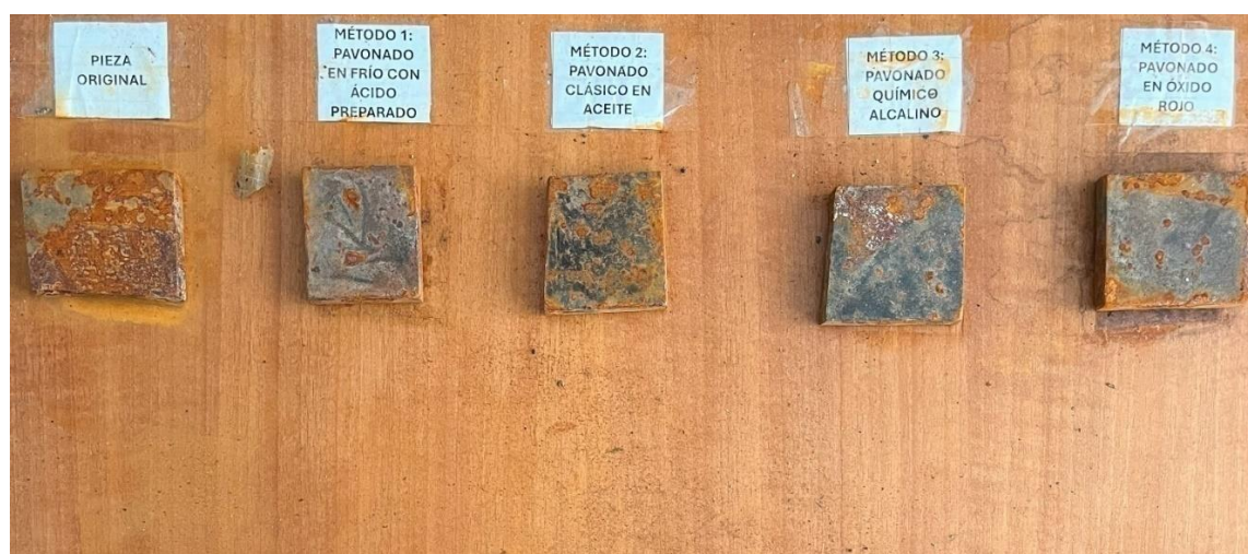
Figura 4-9. Muestras retiradas tras cuatro semanas sumergidas (elaboración propia)
