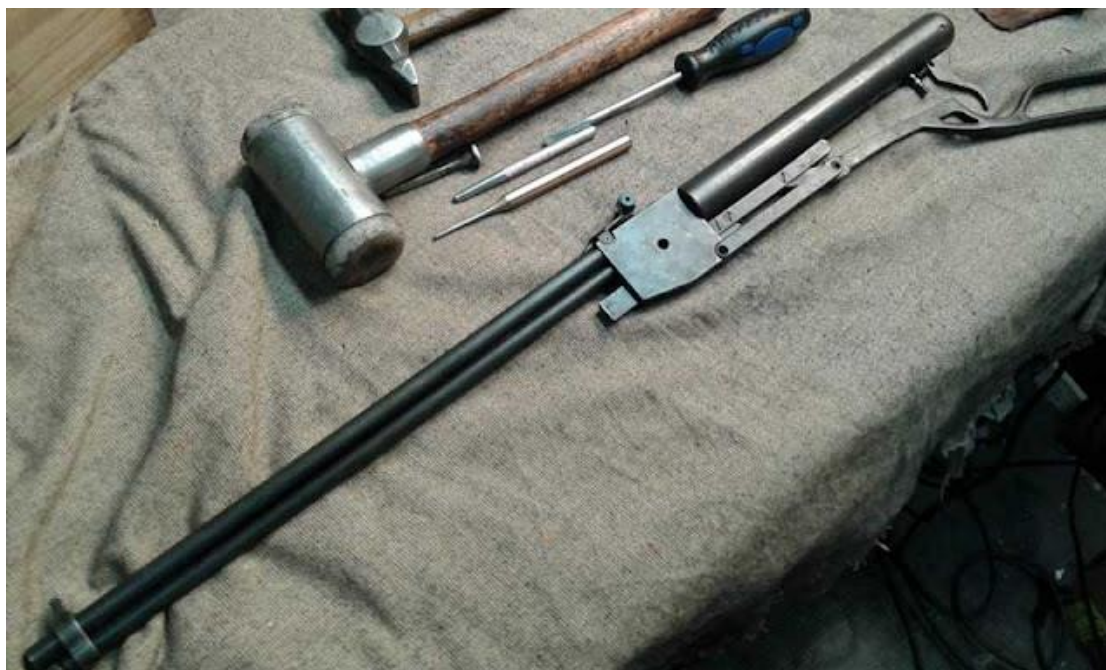
Figura 2-7. Misma Carabina Huracán restaurada utilizando pavonado (tomada de [49])
