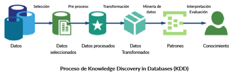
Figura 1-1 Proceso de recopilación y análisis de datos [1]
