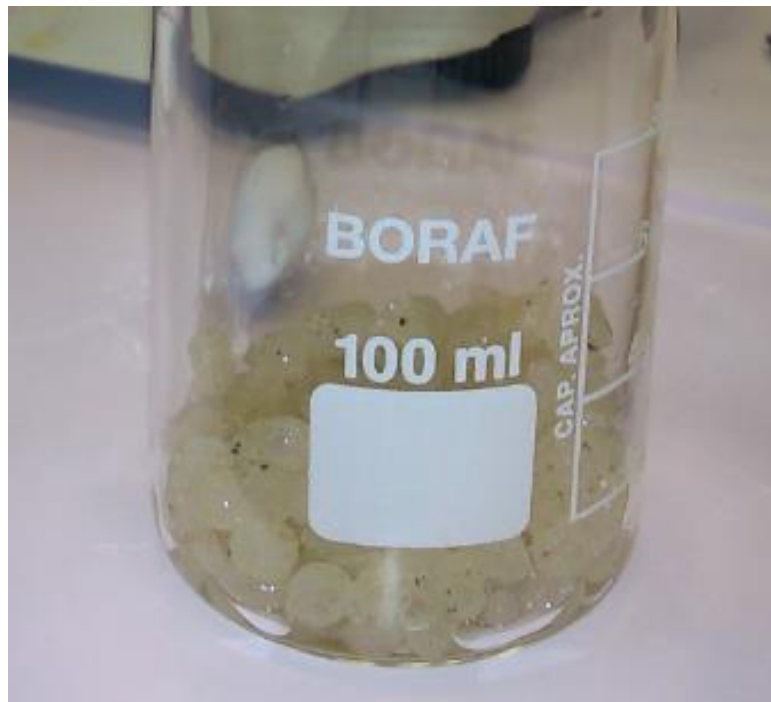
Figura 3-2 Muestra del adsorbente inmovilizado en esferas de alginato cálcico, contenido en un vaso de precipitado de 100 ml de capacidad
