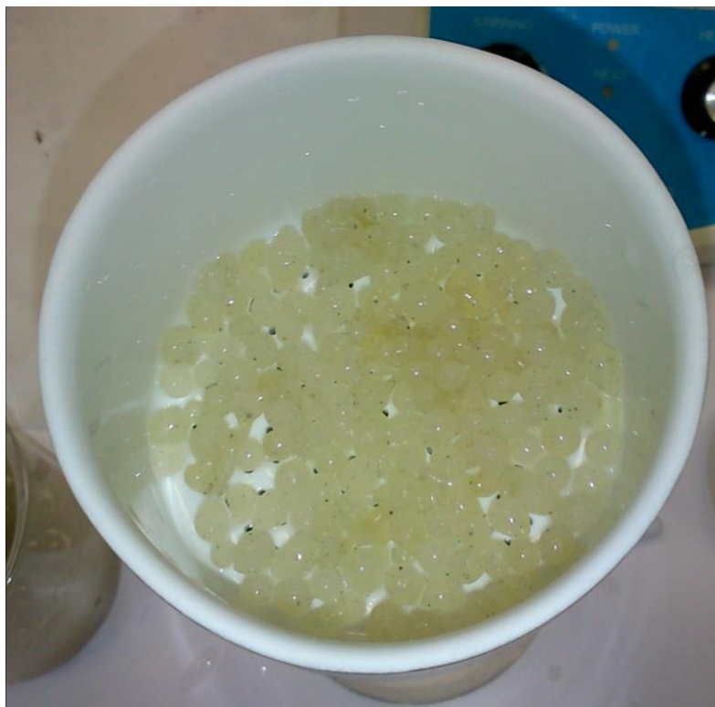
Figura 3-1 Adsorbente recién colado para separarlo de la disolución
