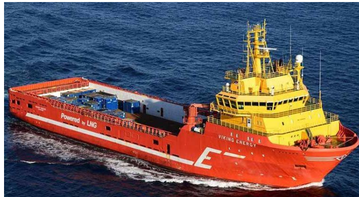
Figura 3-3 Buque de suministro Viking Energy alimentado con GNL [42]
