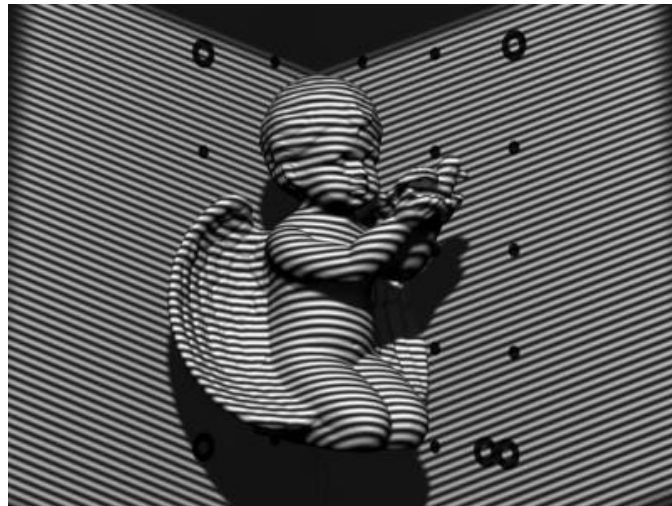
Figura 2-16 Escáner mediante luz blanca [17]
