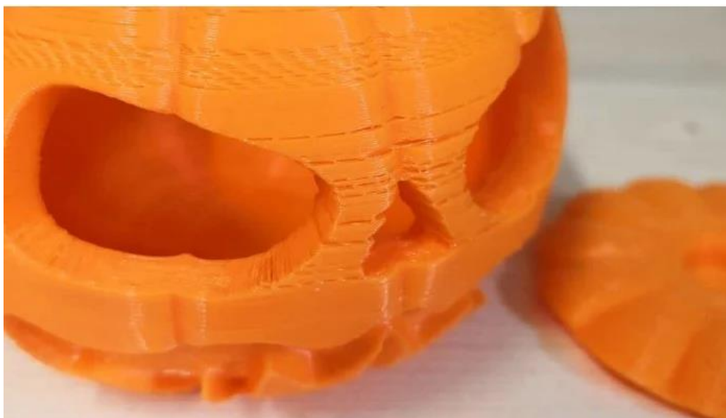
Figura A1-0-1 Error de impresión de separación de capas [20]
