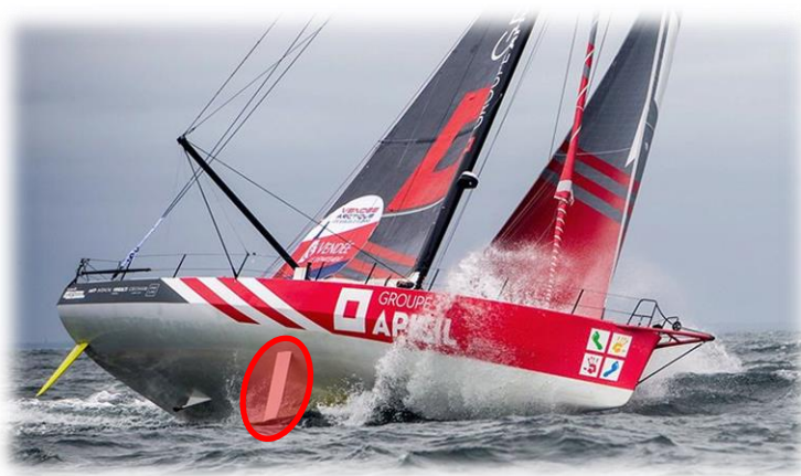
Figura 2-7. Uso de daggerboards en veleros de competición [10]
