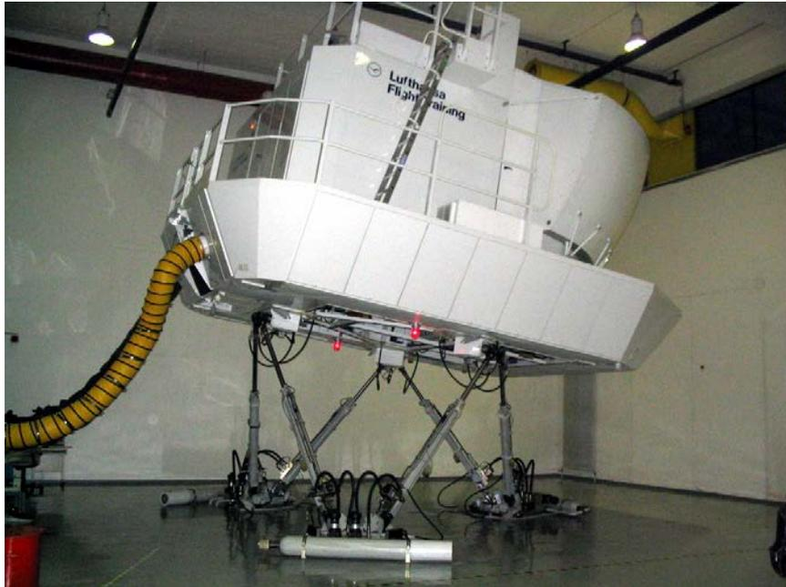
Figura 2-12 Simulador de vuelo 6 DOF de Lufthansa
