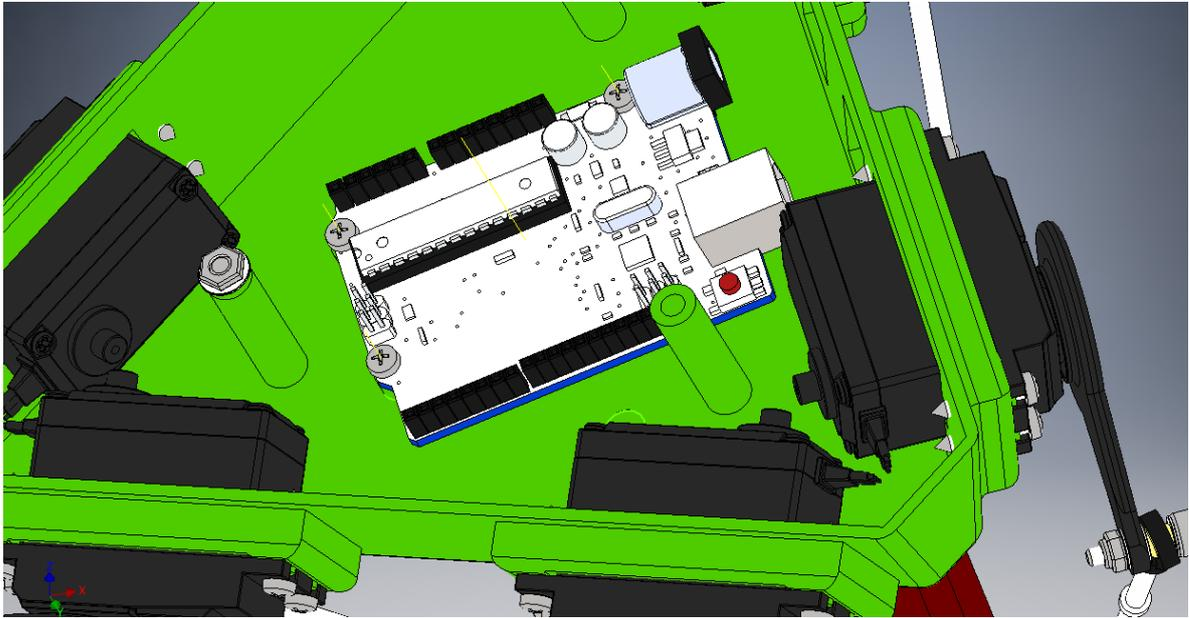
Figura 3-23 Anclaje de la placa electrónica
