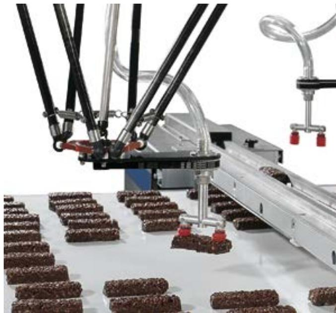
**Figura 2-11 Utilización del Robot Delta en la industria alimentaria**
