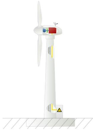
**Figura 20 Aerogenerador de eje horizontal**
