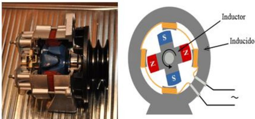
Figura 35 Despiece motor eléctrico y Esquema
