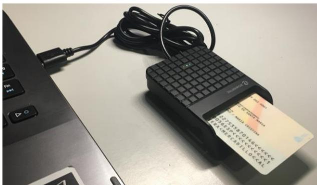
Figura 4-2 Lector de tarjetas con chip.
