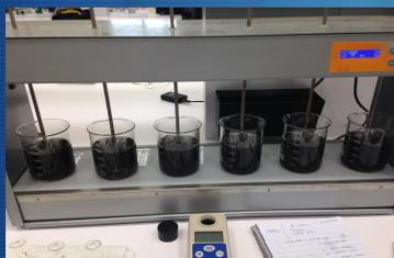
Figura 1. Imagen del floculador utilizado en este trabajo
