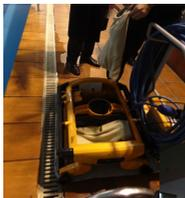
Fig. 2 Robot automático empleado en la piscina que recoge los sólidos sedimentados diariamente (superior) y detalle de la piscina de la ENM (derecha).
