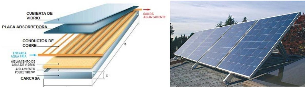
Figura 4-4. Captadores solares planos con cubierta [1]
