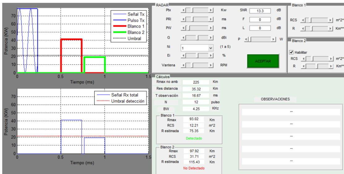
**Figura 4-3 Primer blanco detectado, segundo por debajo del umbral de detección.**
